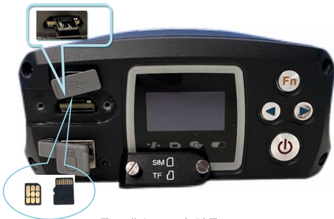
图 4-4 装/取 SIM/TF 卡示意图
